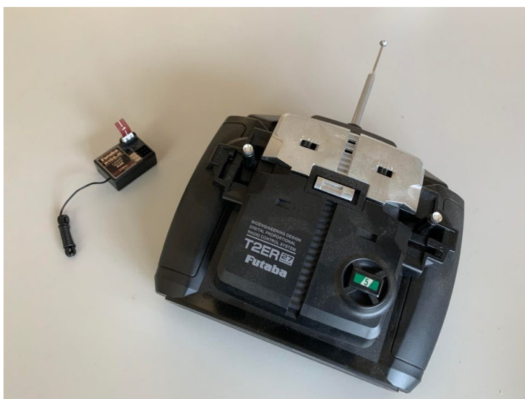
市售 3 通道 27MHz 板型遙控收發器
