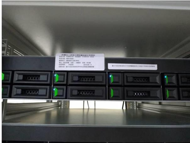
QSAN XN8008R 儲存裝置機架式 2UCPU:IntelR XeonR 3.3GHz，記憶體:8GB，硬碟:8TB\*6，資料備份儲存使用
